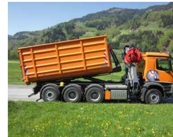
VIERACHSER Neuer Stummer Eurolift Abrollkipper HLK 20 in Schub-/Knick-Ausführung in Verbindung mit einem Recycling Kran, geliefert an die Höller Gruppe, St. Johann.
