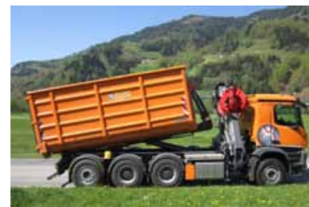
Speziell für die Transport-, Bau- und Entsorgungswirtschaft. Eurolift Abrollkipper mit einer Hubkraft von drei bis 30 Tonnen.
