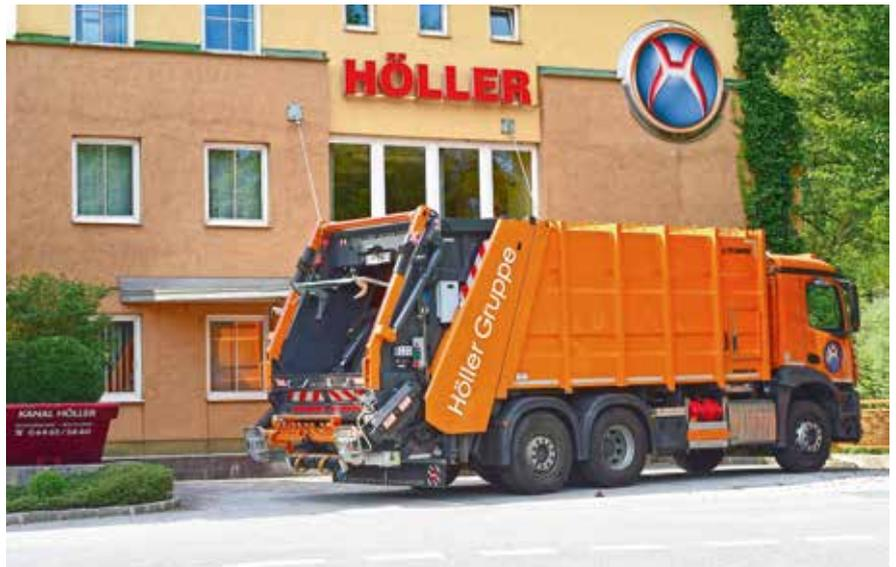
**MAGNUM XXL** Sämtliche über die beiden Liftersysteme gesammelten Abfälle werden über die integrierte Gesamtaufbauverriegelung erfasst. Somit kann eine exakte Verrechnung mit jedem Kunden gewährleistet werden. Das Sammelkastenvolumen beträgt 22 Kubikmeter.
