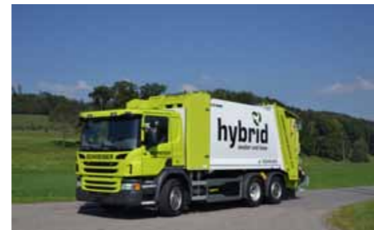
Scania Euro 6-Lastwagen mit Hybrid Antrieb in Kombination mit Stummer Abfallsammelaufbau und PLUG – IN Hybrid. Gegenüber einem herkömmlichen Antriebskonzept können bis zu 30 Prozent Dieseldieselkraftstoff und CO2 eingespart werden.
